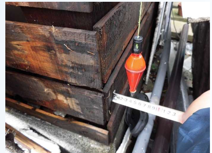
「下げ振り」による傾きの調査
