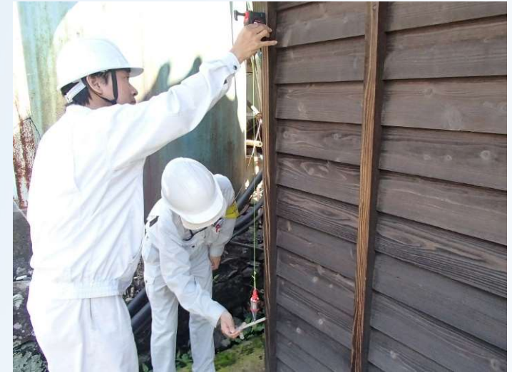
「下げ振り」による傾きの調査
