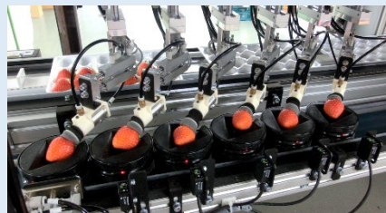
選別・パック詰めロボット(出典：農研機構)
